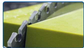
Schnittfläche thermisch entlastet
