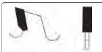
Abb.: Flachzahn konisch (F kon.)
