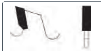
Abb.: Flachzahn konisch (F kon.)
