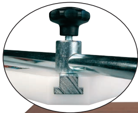
Gleitzapfen in der T-Nut des Kreuzrahmens
